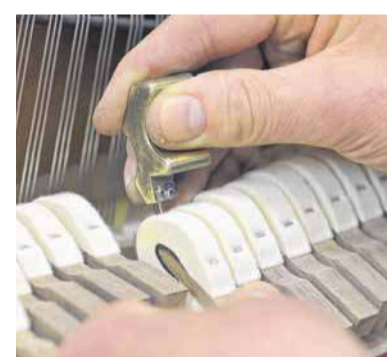
Mit Nadelstichen werden die Hammerköpfe intoniert. FOTO: OH
